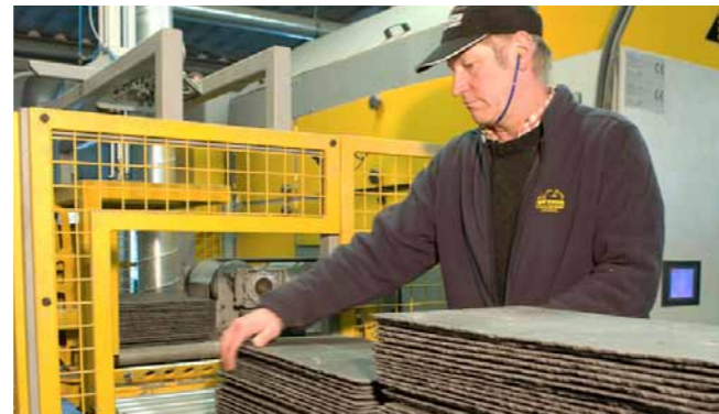
Durchgängige Qualitätskontrollen sichern eine optimale Schieferqualität – unser Schiefer durchläuft in jedem Prozess eine Kontrolle und wird vor Auslieferung einer Klang- und Sichtprobe unterzogen.
